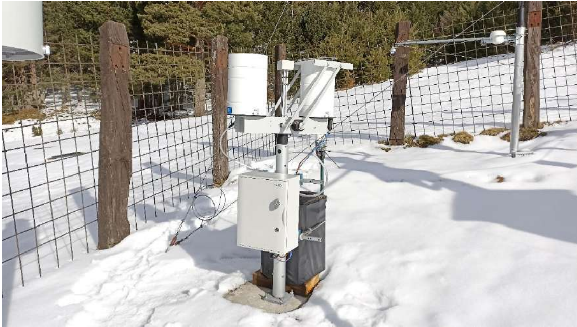
Figura 43. Colector de depósito atmosférico húmedo y seco instalado el puerto de Los Cotos.
