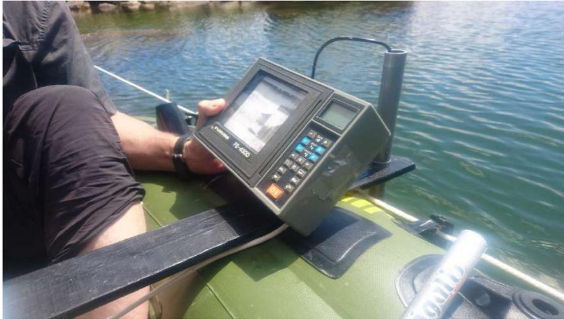
Figura 1. Ecosonda FURUNO 4300, utilizada en la batimetría de 1991 y la de 2018.
