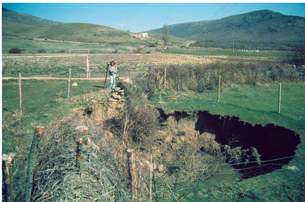
Figura 14. Microdolina de colapso al noreste de la localidad de Lozoya (próximas al polideportivo), ocasionada durante el proceso de aforo del acuífero cárstico. Fotografía tomada en marzo de 1985.
